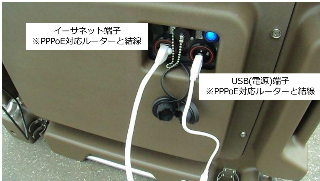
図-7 ポジモと PPPoE 対応ルーターの接続
