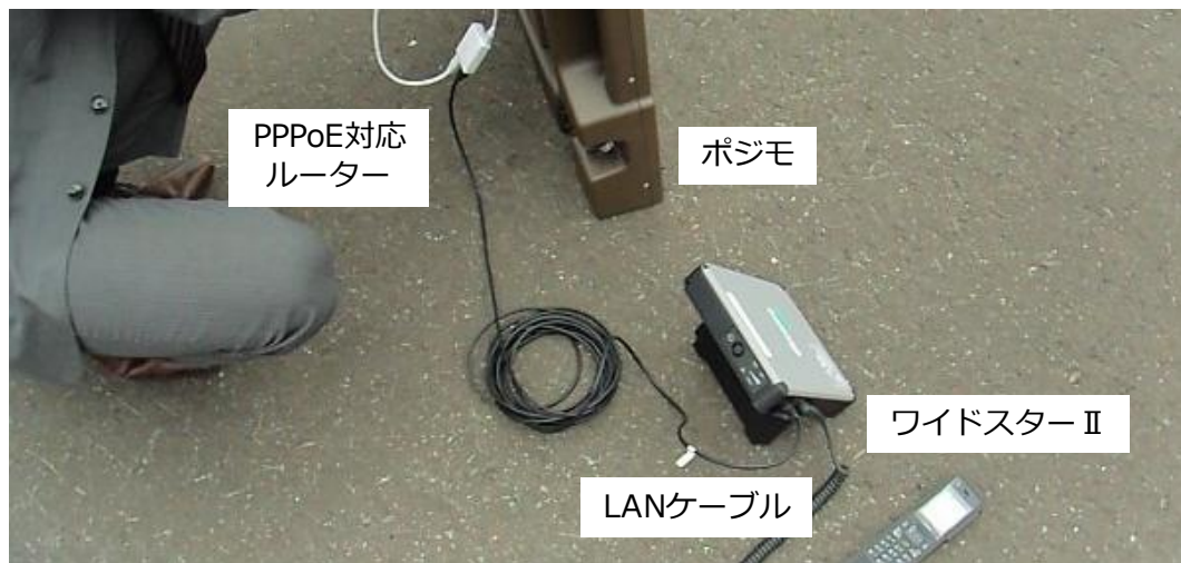
図-5 ワイドスターⅡに LAN ケーブルを接続 ワイドスターⅡの LAN ケーブルコネクタは、側面についています。
