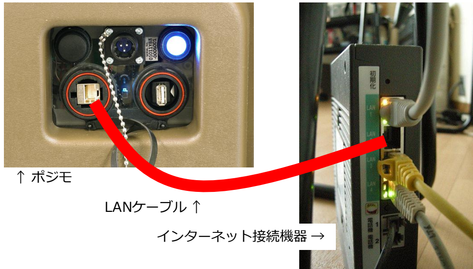
図-3 ポジモとインターネット接続機器の結線
