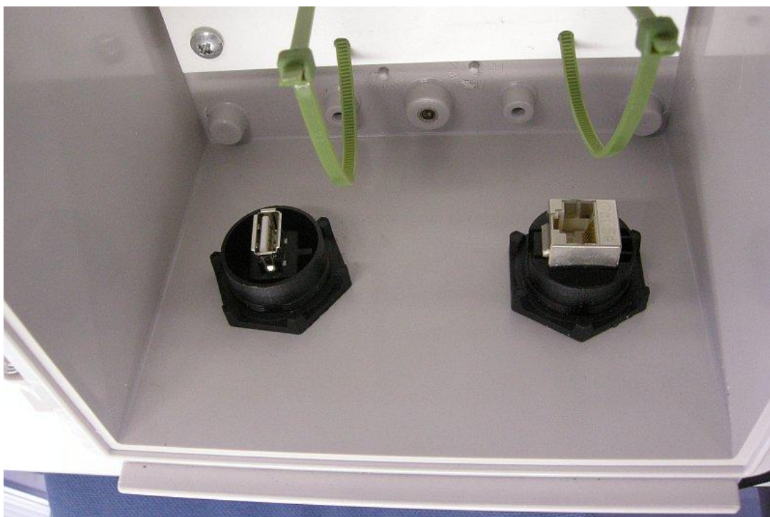
図-3 イーサネットコネクタ(右)と USB コネクタを(左)を防水プラボックス Type 2 に取り付けた内面
