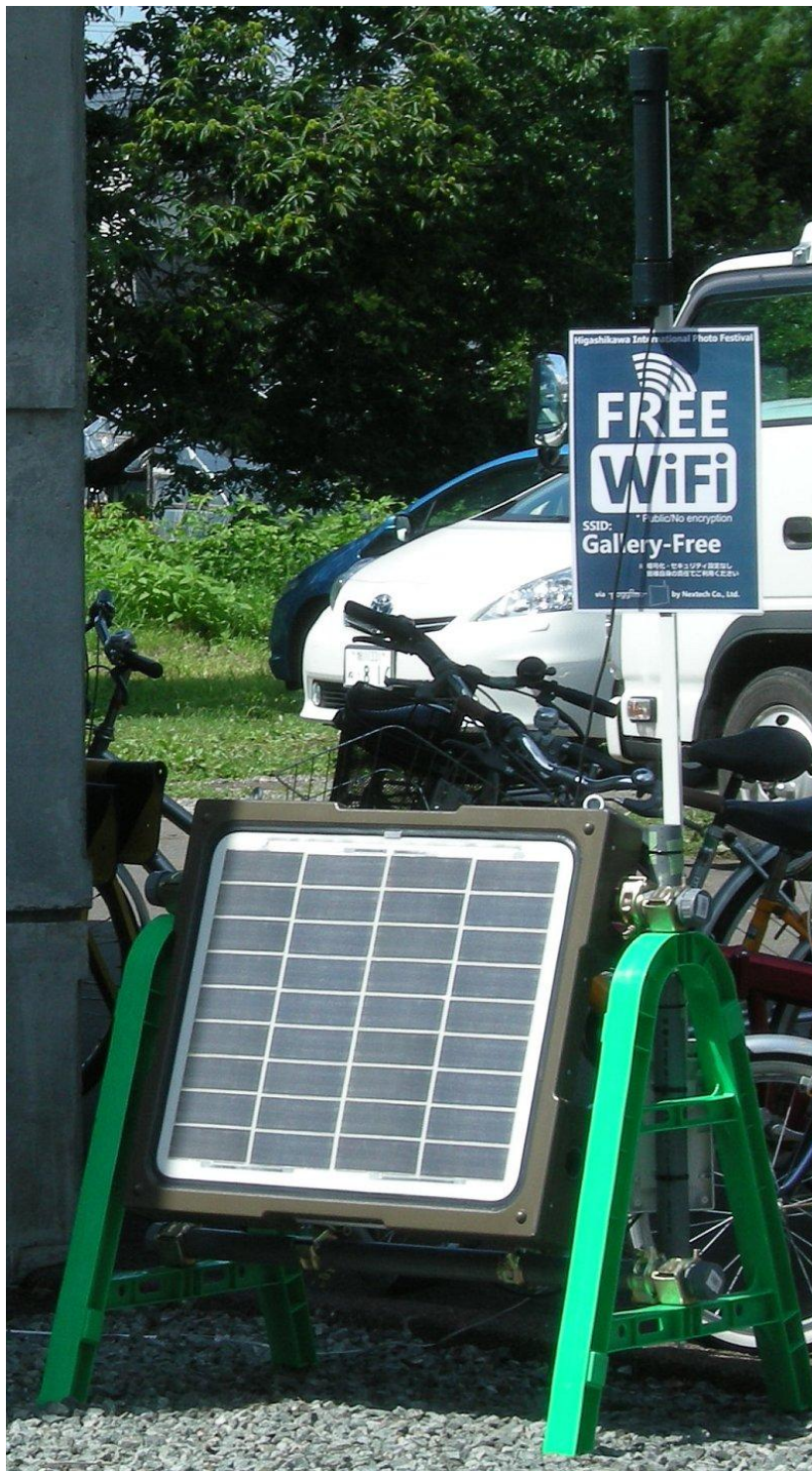
図-1 バリケードスタンドと塩ビ管による設置
