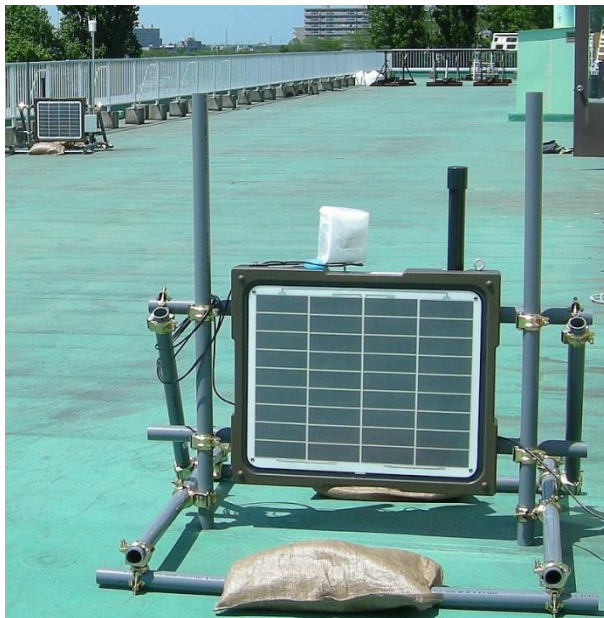
図-5 塩ビ管と単管クランプ(前面)
