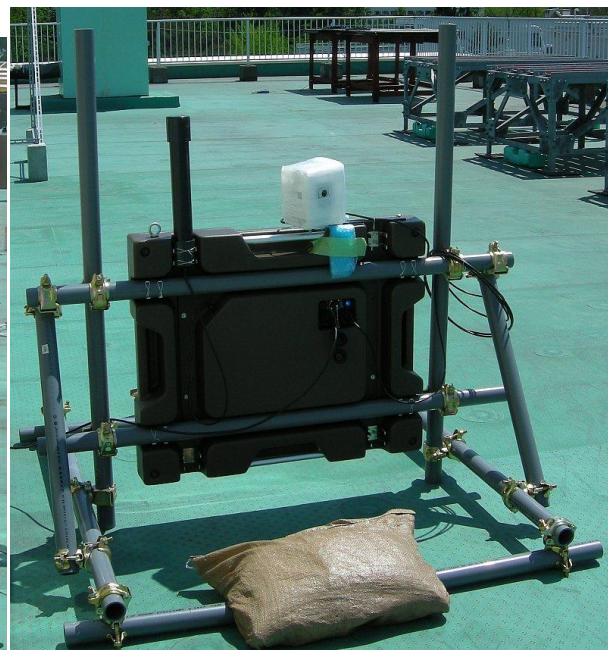
図-6 塩ビ管と単管クランプ
